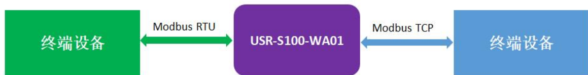
图 6 Modbus RTU & Modbus TCP 互转
